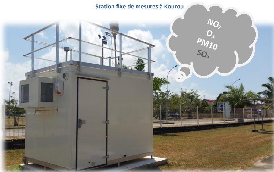
Station fixe de mesures à Kourou
