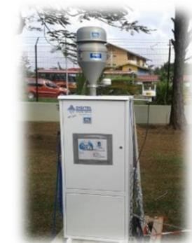
En 2016, la surveillance du B(a)P, traceur des HAP, a continué. Les prélèvements des HAP présents en phase particulaire s'effectuent sur filtres grâce à un préleveur haut débit DA80 avec une tête PM10. Le filtre est exposé pendant 24h.
