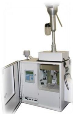
Concernant les métaux (Arsenic, Cadmium, Nickel et Plomb), les prélèvements s'effectuent grâce à un préleveur bas débit appelé « Partisol 2025 », lui aussi équipé d'une tête PM10. Le filtre est exposé pendant 7 jours consécutifs à un débit constant de 1m<sup>3</sup>/h. Comme pour le benzène et le B(a)P, les seuils ne sont pas dépassés. L'évaluation préliminaire se poursuivra en 2017, à Matoury pour la ZUR et toujours à Kourou dans la ZR.
